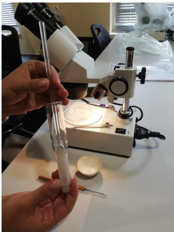
**Slika 3.8.** Drobiljenje cista u Huijsmansovom homogenizatoru (Herak, 2019)
