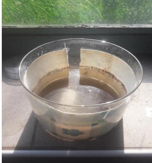
**Slika 3.3.** Izdvajanje cista iz ispranog uzorka pomoću posude obložene PVC trakom (Herak, 2019)
