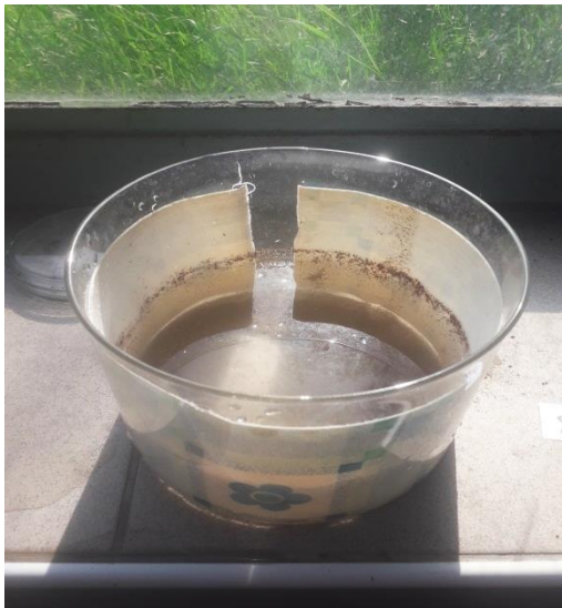
Slika 3.3. Izdvajanje cista iz ispranog uzorka pomoću posude obložene PVC trakom (Herak, 2019)
