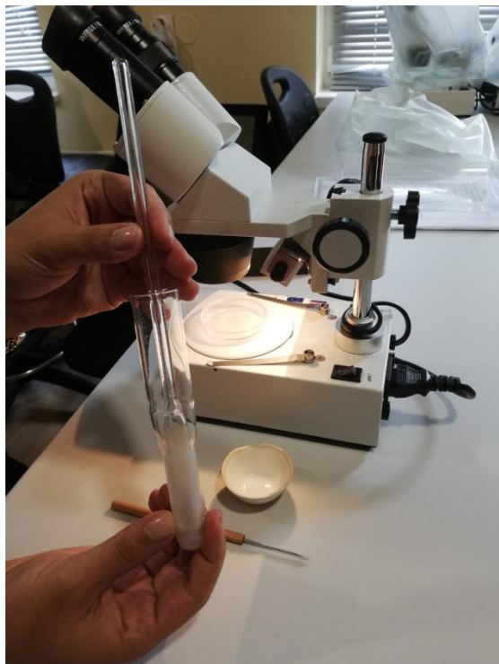
Slika 3.8. Drobljenje cista u Huijsmansovom homogenizatoru (Herak, 2019)
