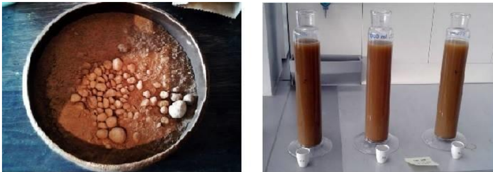
Slika 11. i 12. Određivanje mehaničkog sastava tla
