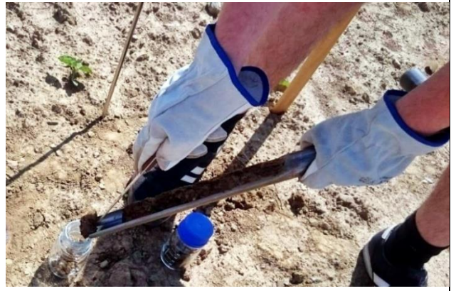
Slika 8. Uzimanje uzoraka tla pedološkom sondom tijekom vegetacije
