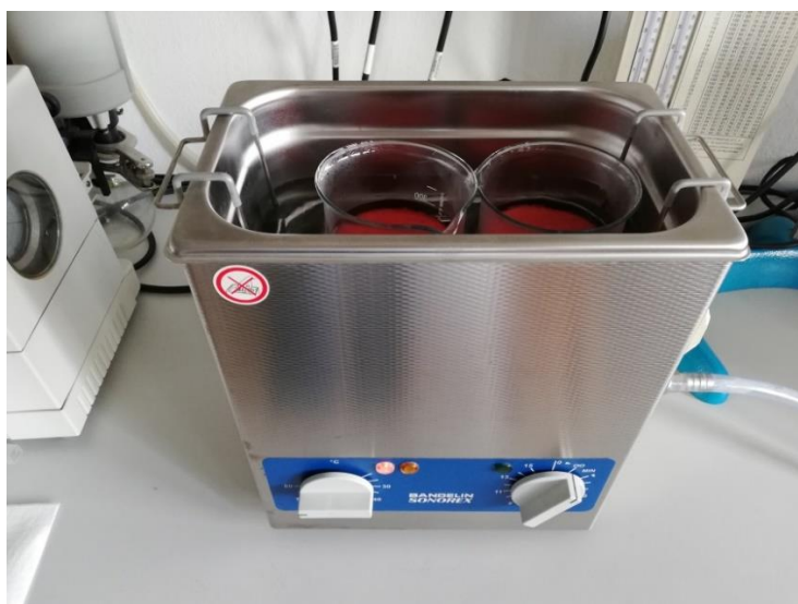
Slika 3.2.1. Ultrazvučna kupelj „Bandelin” RK 103H (Foto: Jasenko, 2019.)
