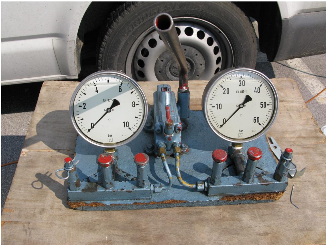
Slika 4.2. Mehanički uređaj za kalibraciju manometra
