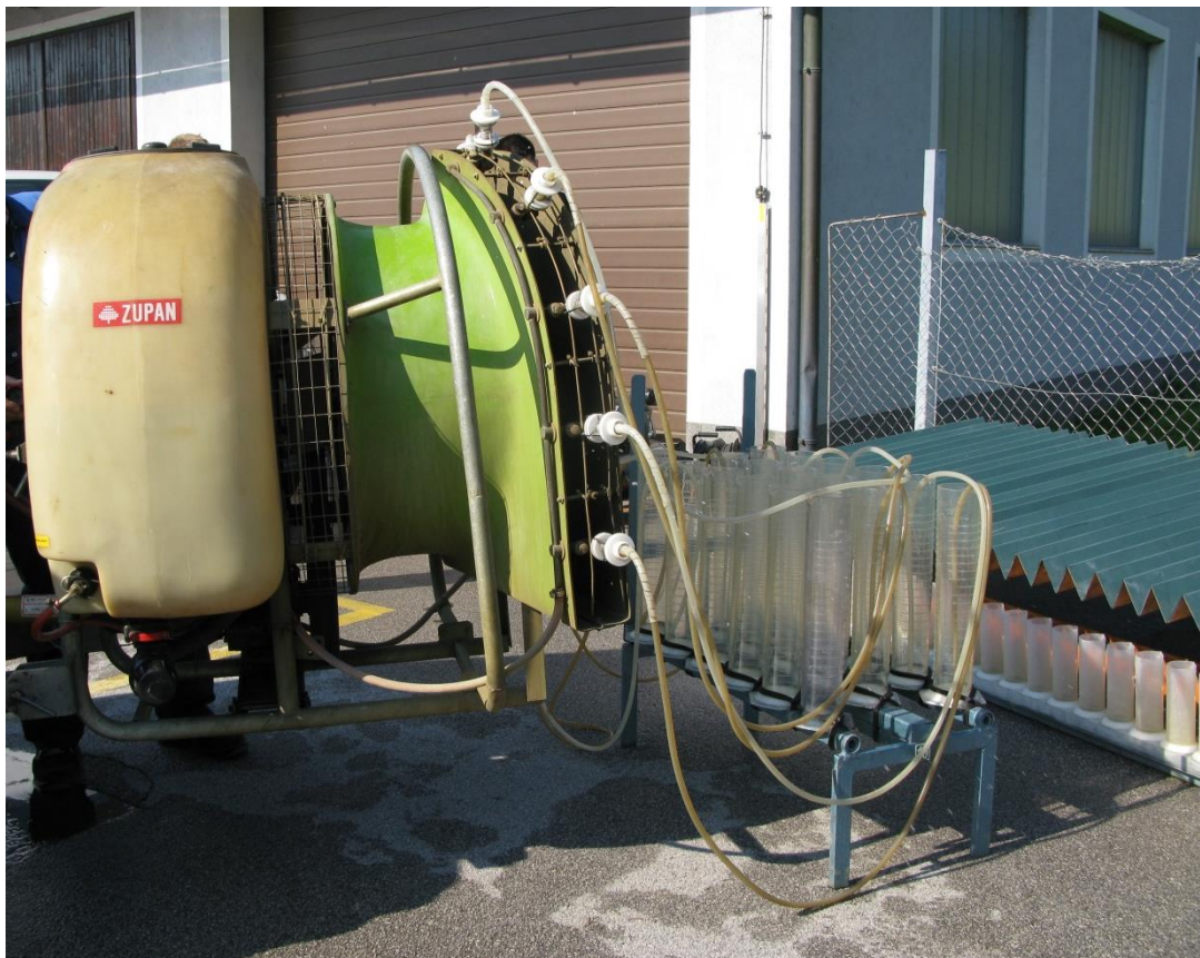
Slika 4.3. Mjerenje protoka mlaznica
