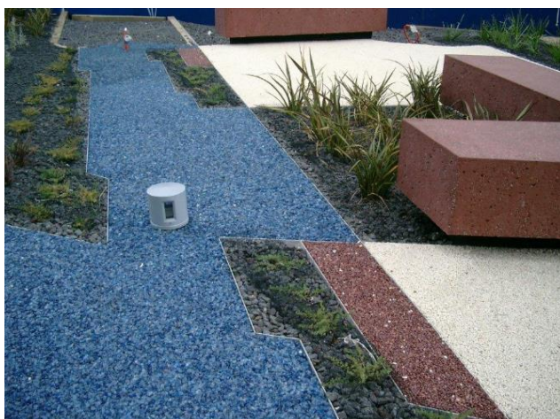
Slika 28. Reciklirani stakleni malč
