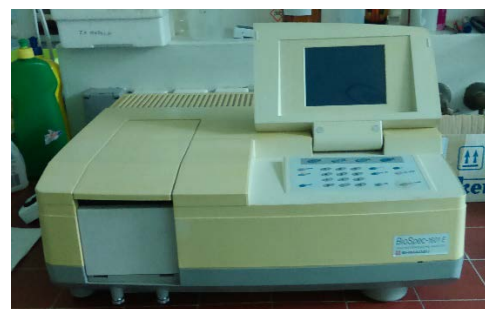
Slika 3.1.5. Shimadzu BioSpec-1601 E UV- Vis spektrofotometar
