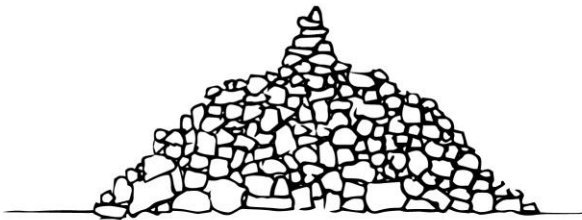
Zasuta gomila s nadozidanom međom
