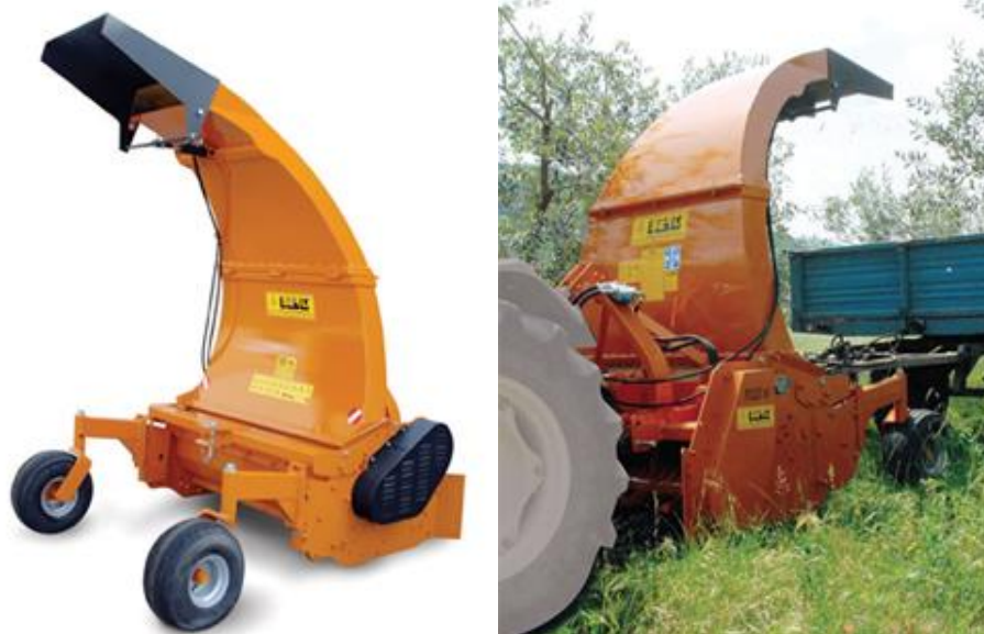
Slika 8. Malčer s puhajućom cijevi
