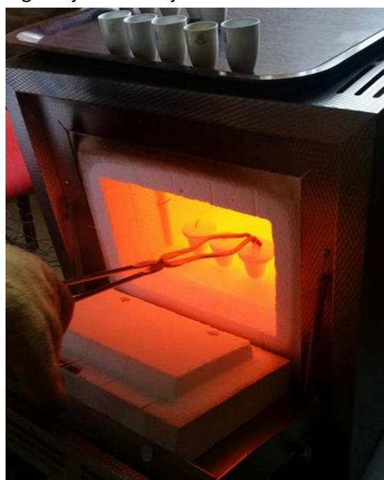
Slika 3.2.3.1: Određivanje sadržaja koksa u mufolnoj peći
