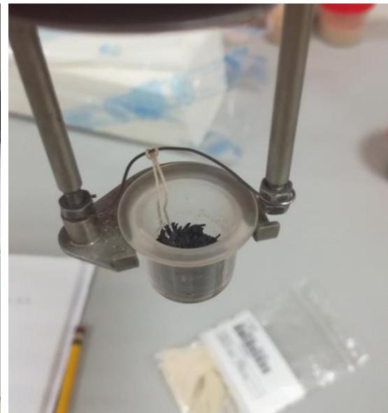
Slika 3.2.8.2: uzorak za kalorimetriju
