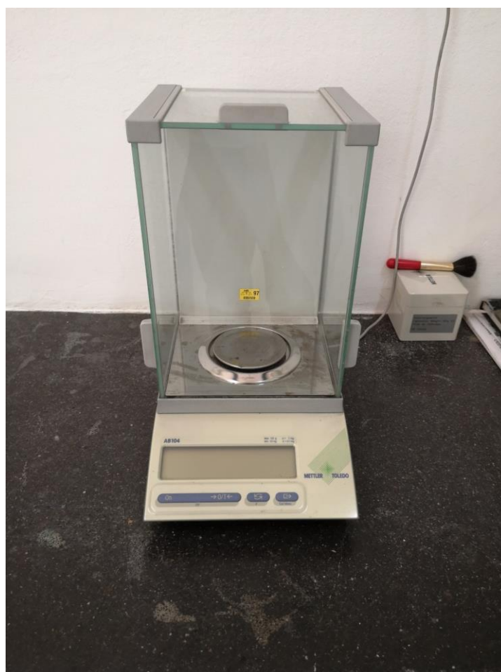
Slika 4.2.1. Analitička vaga (Mettler Toledo AB104)
