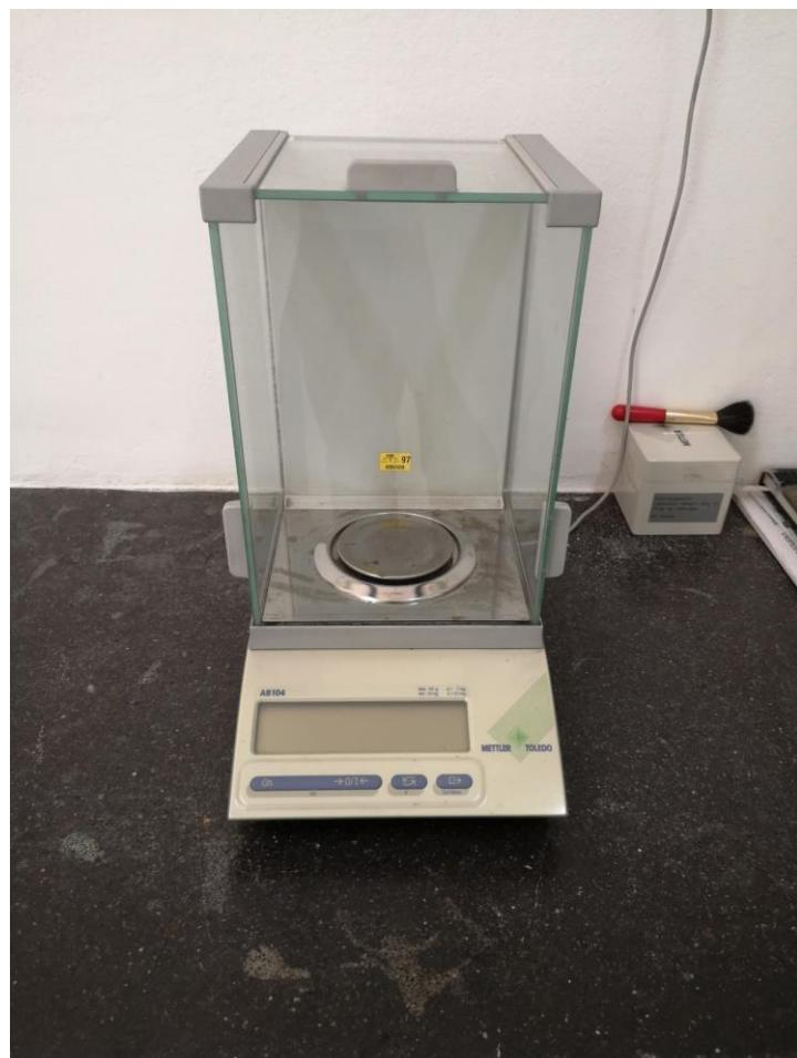
Slika 4.2.1. Analitička vaga (Mettler Toledo AB104)
