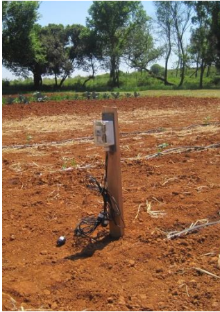
Slika 43. Sakupljač podataka i četiri senzora za FAR, 5. svibnja 2011.
