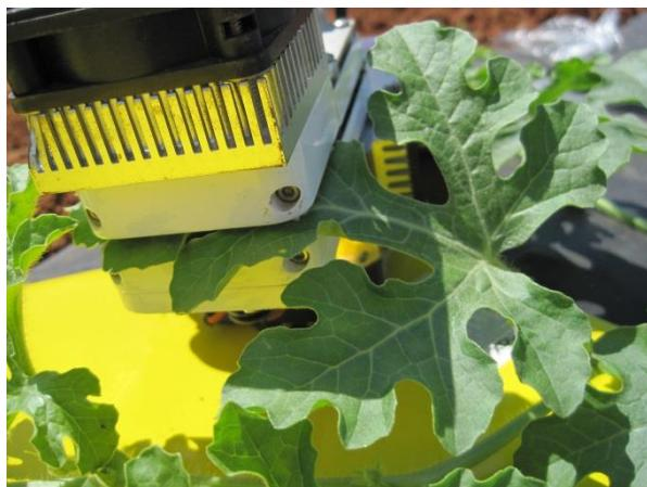
**Slika 20.** Komora instrumenta pričvršćena za gornju trećinu lista, 14. lipnja 2010.
