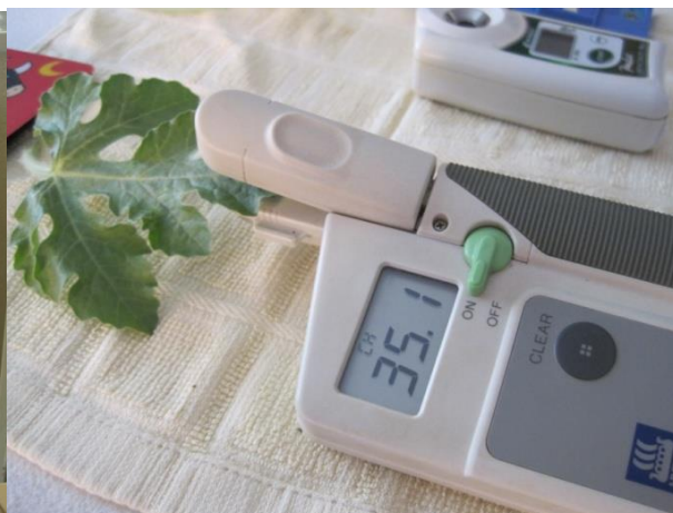
Slika 16. Mjerenje indeksa klorofila HNT klorofilmetrom; 14. 6. 2010.
