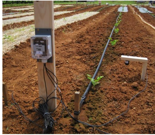
Slika 44. Sakupljač podataka i PAR senzor okrenut prema nepokrivenom tlu, 31. svibnja 2010.
