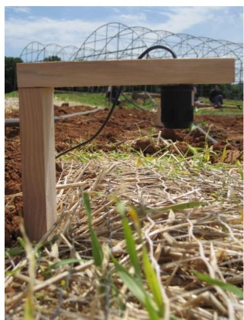
Slika 42. Senzor za *FAR* senzor okrenut prema malču od slame, 31. svibnja 2010.
