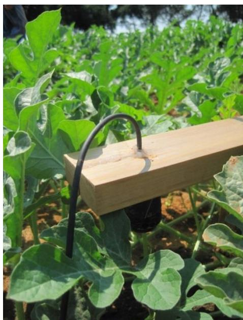
Slika 41. Senzor za *FAR* unutar usjeva, okrenut prema tlu, 12. srpnja 2010.
