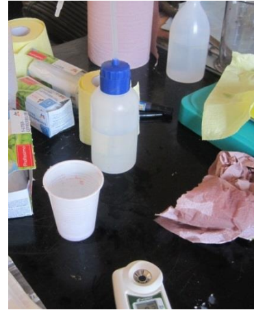
Slika 32. Očitavanje topive suhe tvari, 12. kolovoza 2010.
