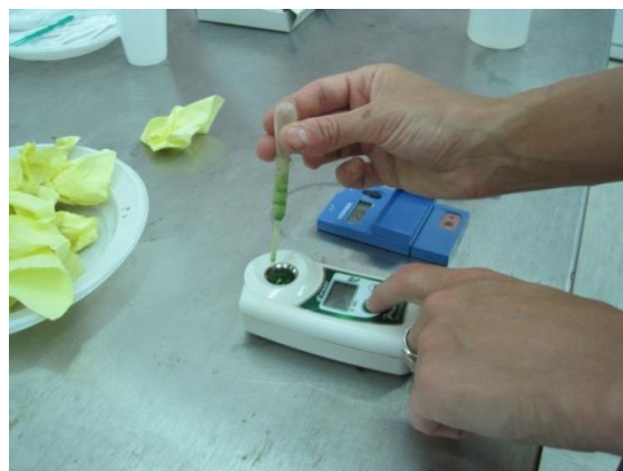
Slika 18. Očitavanje topive suhe tvari lista ( ^{\circ} Brix); 29. lipnja 2010.
