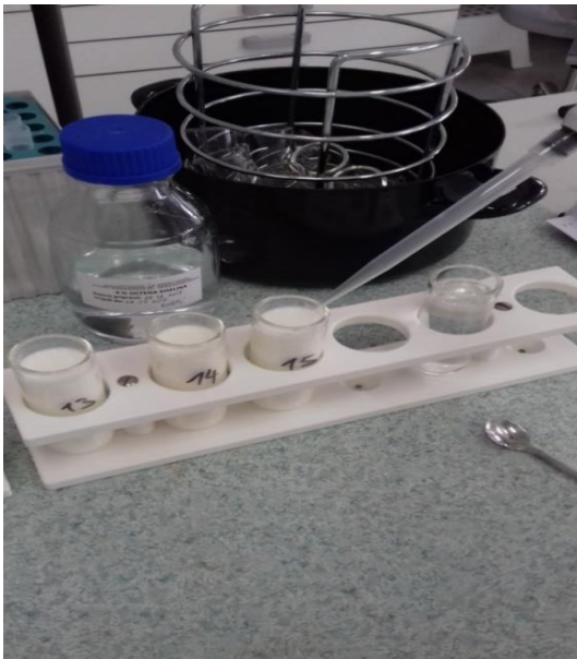
Slika 3.2. Taloženje bjelančevina dodatkom octene kiseline (Izvor: Zorić, 2018.)
