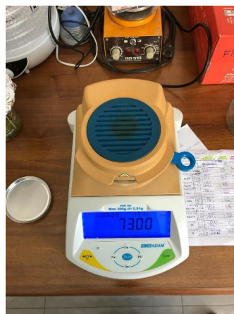
Slika 3.3.2. Halogeni vlagomjer za utvrđivanje količine suhe tvari Snimio: Filip Haramija
