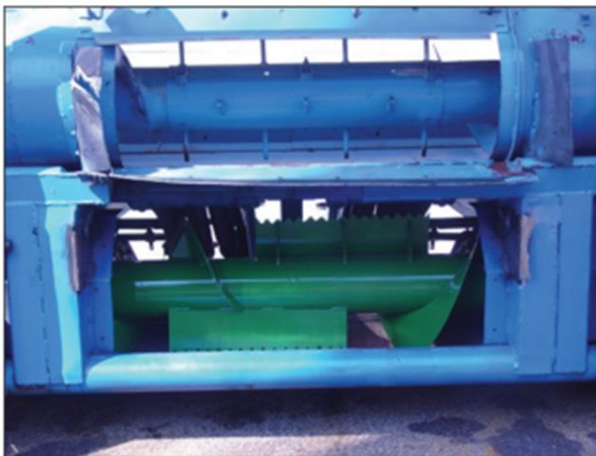
Slika 5. Adapter koji razdvaja klip od ostatka biljke kukuruza
