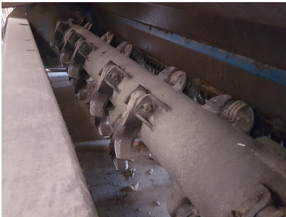
Slika 7. Čekići na osovini malčera
