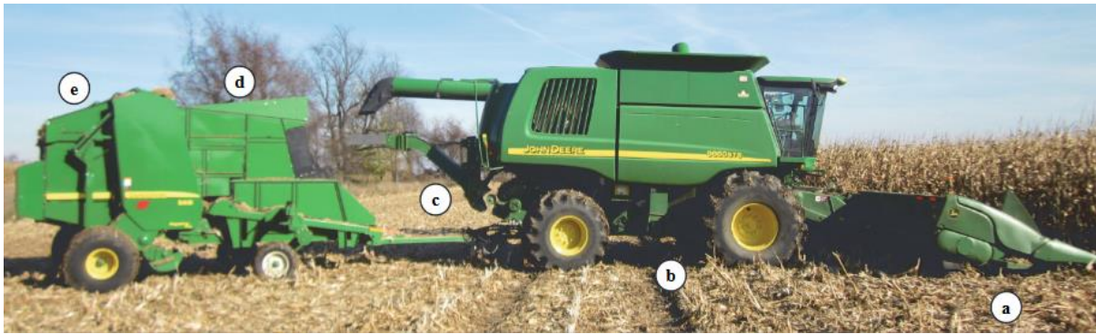
Slika 3. Berba kukuruza i sakupljanje žetvenih ostataka u jednom prohodu
