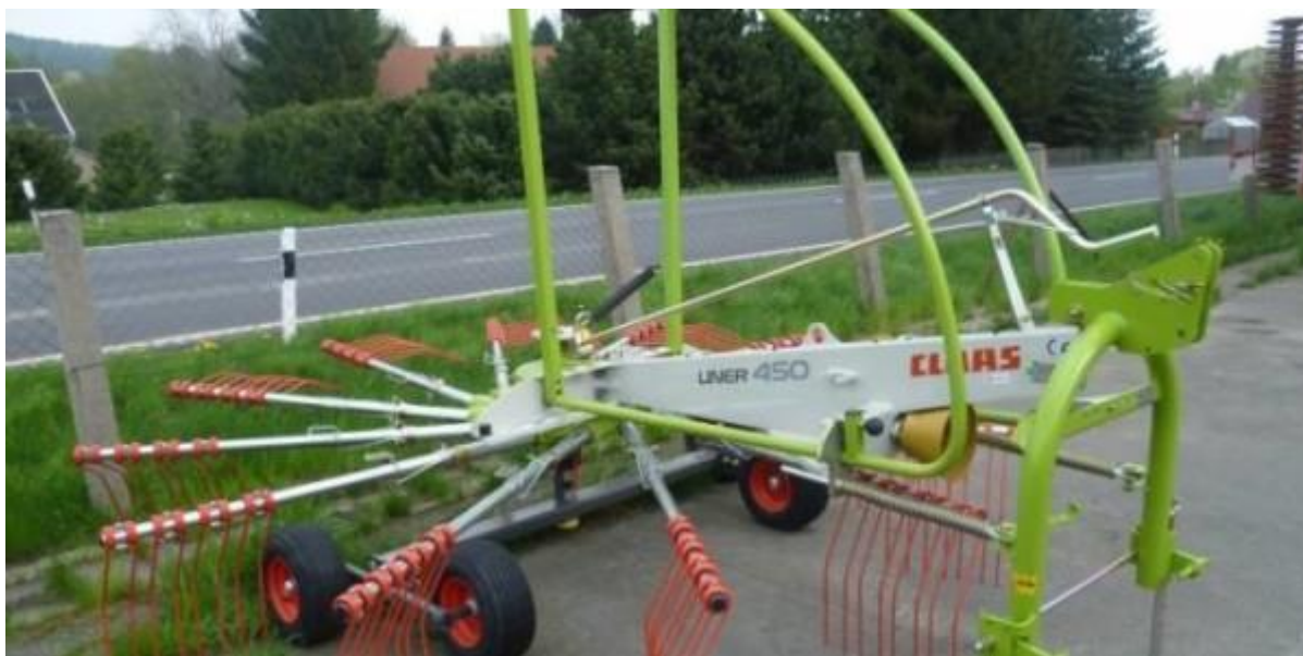
Slika 8. Rotacijske grablje sa tandem podvozjem marke Class
