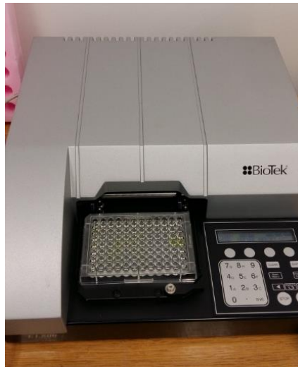
Slika 21. Spektrofotometar ELX800 (Biotek, SAD) (Izvor: original)
