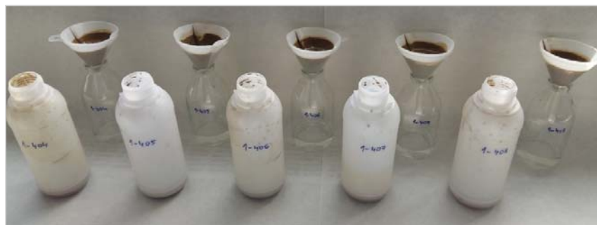
Slika 79: Filtriranje uzoraka nakon ekstrakcije
