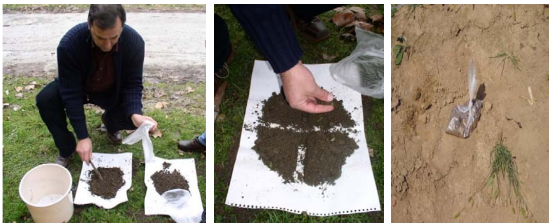
Slika 51: Formiranje prosječnog uzorka tla postupkom „četvrtanja“
