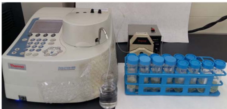
Slika 99: Očitavanje na spektrofotometru
