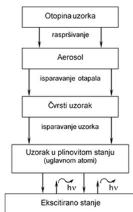
Slika 12: Shema procesa u plamenom fotometru
