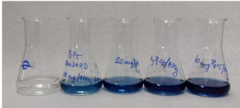
Slika 91: Serija standardnih otopina za baždarenje spektrofotometra
