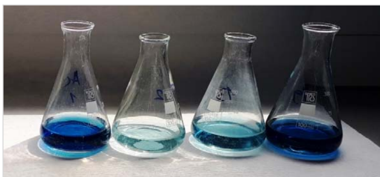
Slika 90: Obojani uzorci za određivanje fosfora
