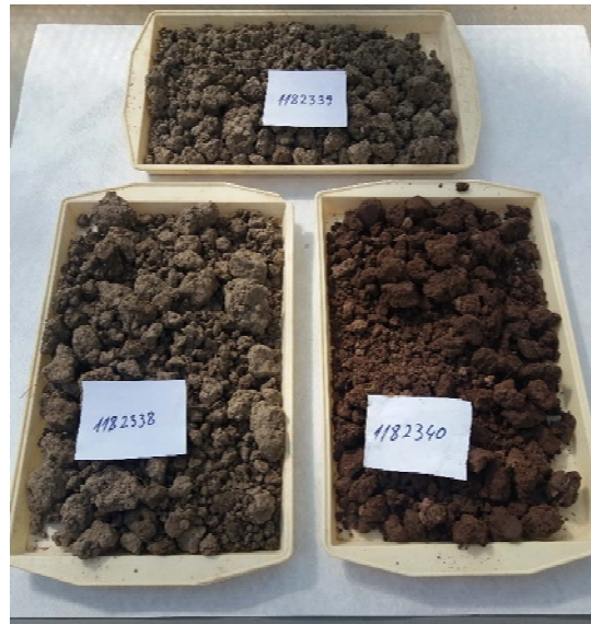
Slika 54: Sušenje uzoraka tla na zraku
