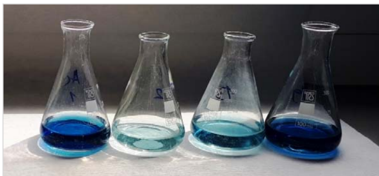
Slika 90: Obojani uzorci za određivanje fosfora
