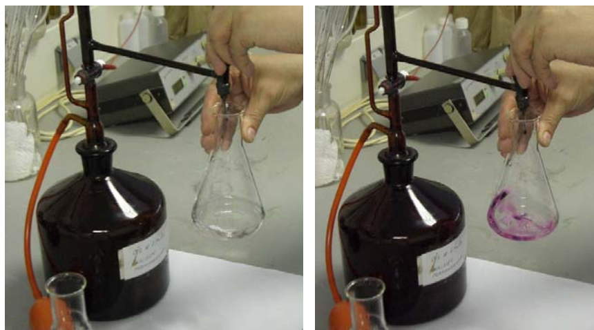
Slika 67: Titranje kalijevim permanganatom
