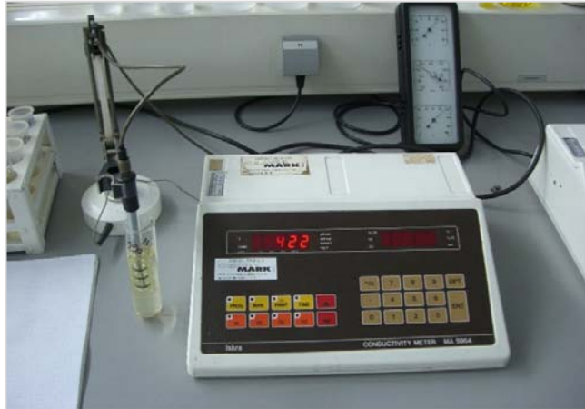
Slika 62: Očitavanje električne vodljivosti na konduktometru
