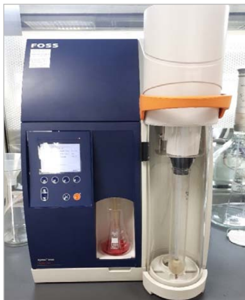
Slika 77: FOSS aparat za destilaciju ukupnog dušika
