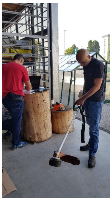
Slika 11. - Trimer s motorom s unutarnjim izgaranjem marke STIHL FS 56 R
