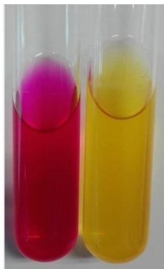
Slika 16. Prikaz pozitivne (lijevo) i negativne (desno) reakcije na razgradnju uree
