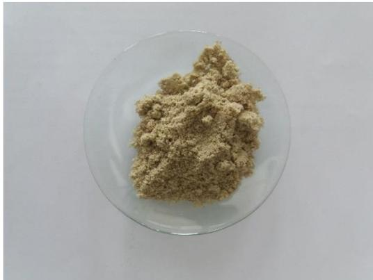
Slika 16. Prah sikavice dimenzije čestica 160  $\mu\text{m}$
