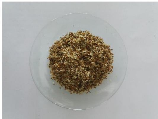
Slika 17. Prah sikavice dimenzije čestica 630  $\mu\text{m}$
