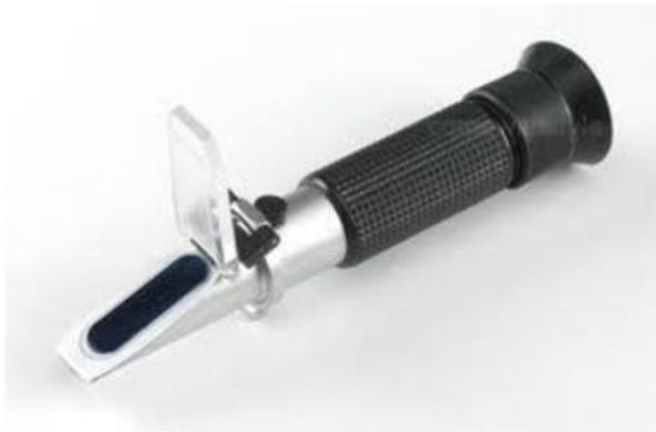
Slika 3. Refraktometar i mjerne skale (Izvor – Internet)
