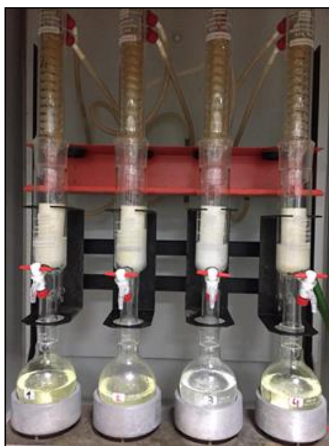
Slika 10. Aparat za ekstrakciju masti po Soxhletu (Izvor: vlastita fotografija)
