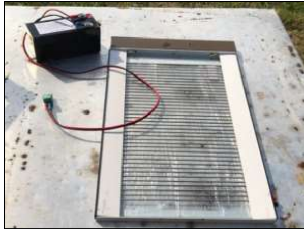
Slika 9. Elektrostimulacijski skupljač otrova
