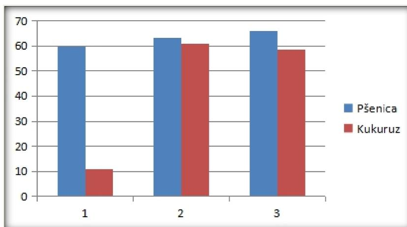
Slika 20. Udio fiksiranog ugljika (%) u biougljenu
