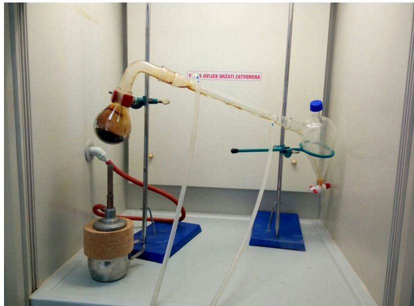
Slika 11. Sustav za provođenje laboratorijskog procesa pirolize
