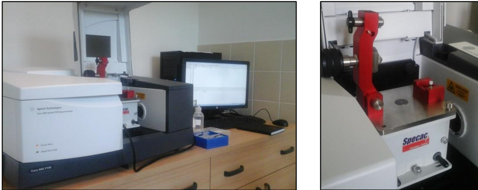
Slika 9. FTIR spektrometar s računalom za pohranu i obradu spektralnih podataka (lijevo) i ATR instrumentalnim dodatkom (desno)
