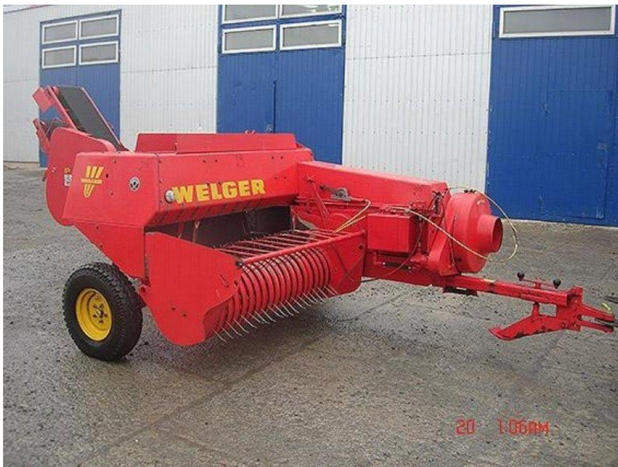
Slika 8. Preša za male četvrtaste bale
