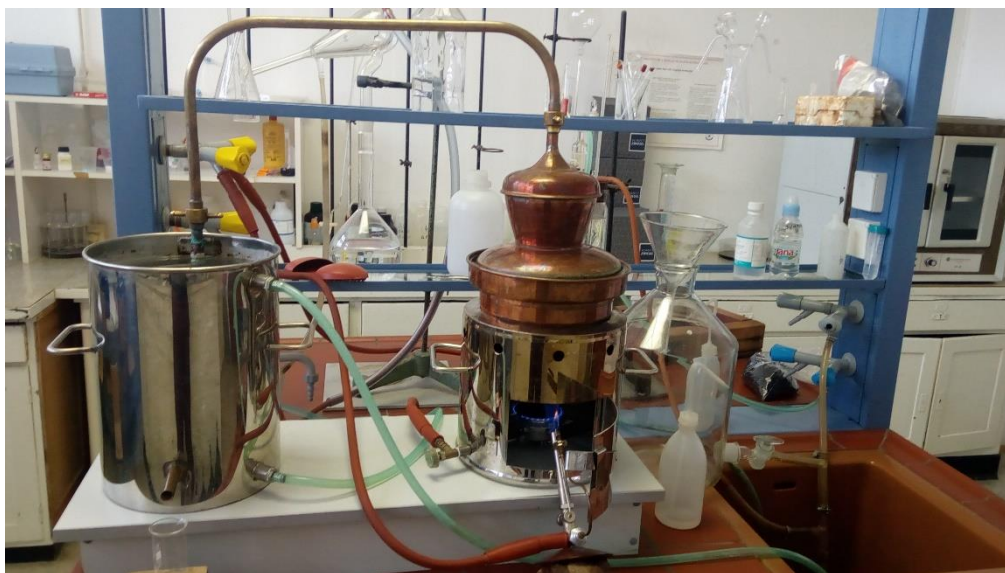
Slika 3.6. Jednostavni destilacijski uređaj alambic kapaciteta 5 L (Izvor: autor)
