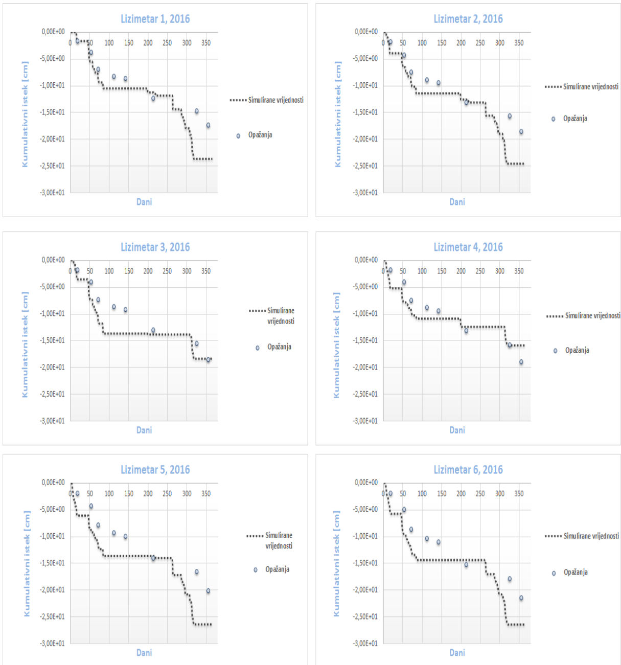
Slika 24. Izmjerene i simulirane (HYDRUS-1D) kumulativne vrijednosti procjedne vode (perkolata) iz lizimetara u 2015. godini
