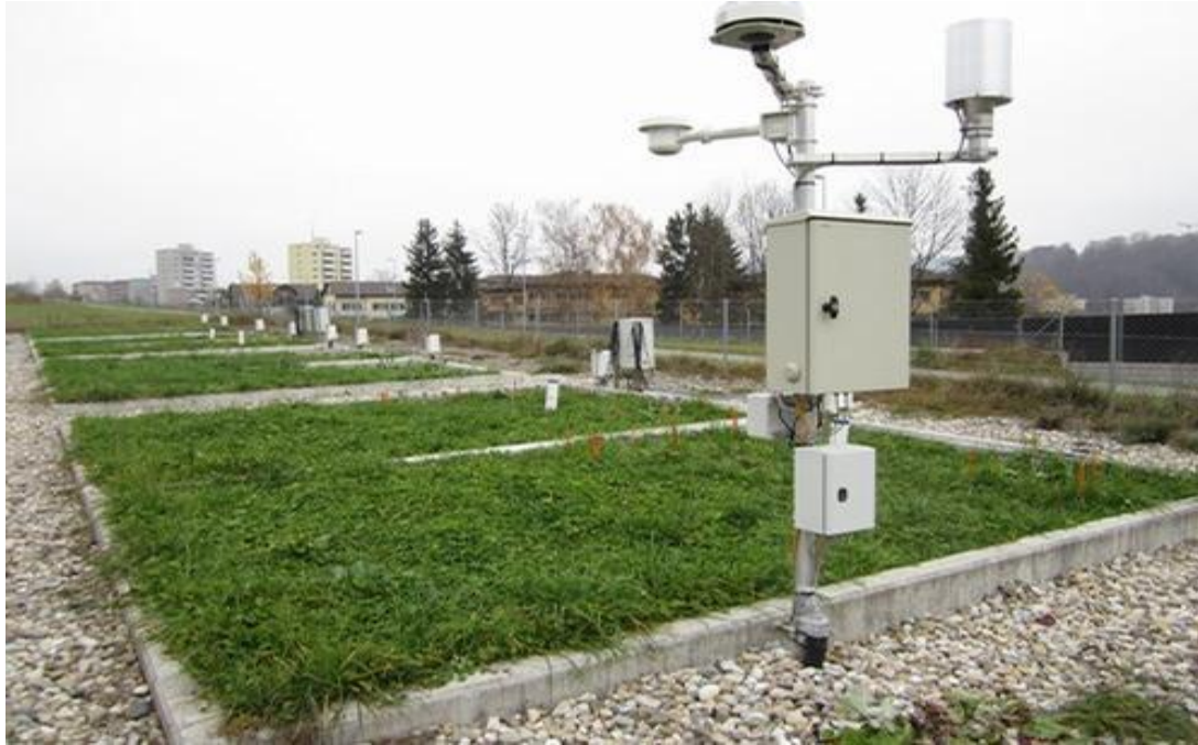
Slika 5. Pravokutni lizimetar (Izvor: http://www.soilprot.ethz.ch )
