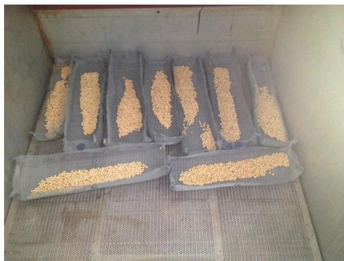
Slika 22: Tostiranje soje u laboratorijskom tosteru (izvor: vlastiti)
