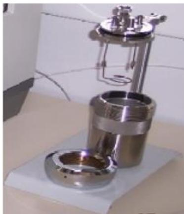
Slika 31: Kalorimetrijska bomba
