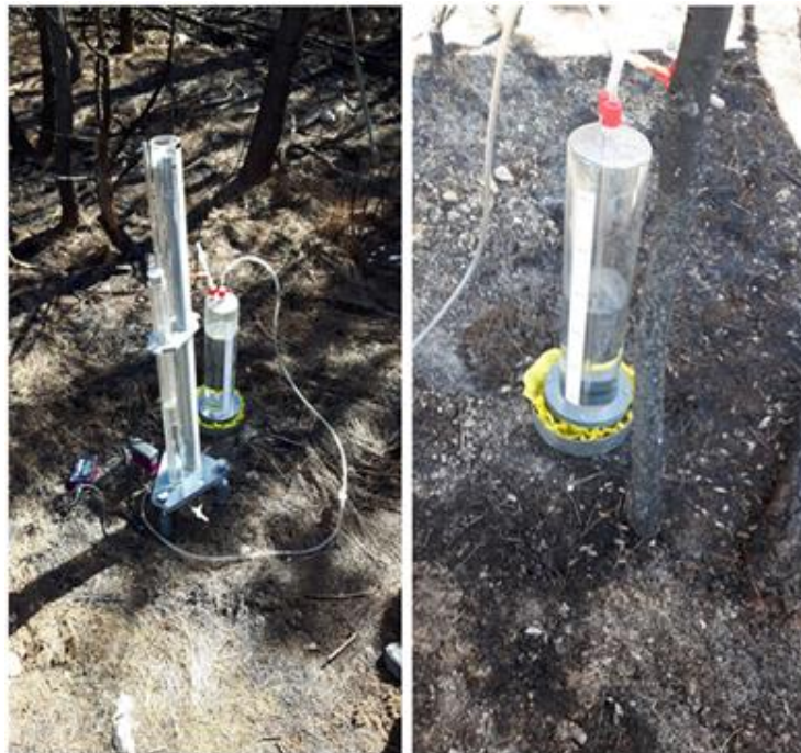
Slika 11. Terensko izvođenje pokusa infiltracije uz kontinuirano praćenje količine vode u tlu pomoću sonde TDR300 (FieldScout, Spectrum Technologies, Inc.) na lokaciji Žaborić
