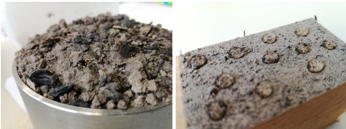
Slika 6. Foto prikaz kapljice vode zadržane na površini neporušenog hidrofobnog uzorka prilikom WDPT testa (lijevo) i MED (prilagođeni) test na porušenom uzorku (desno)
