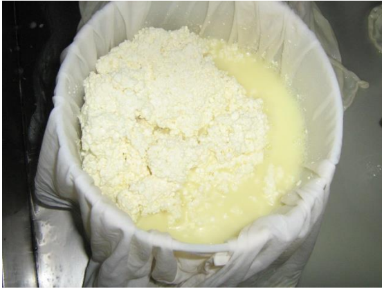
Slika 3.1.4. Izdvajanje sirutke bez prešanja
