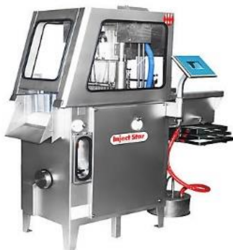
Slika 2.1.4.2. Uređaj za salamurenje mesa pikl-injektor
