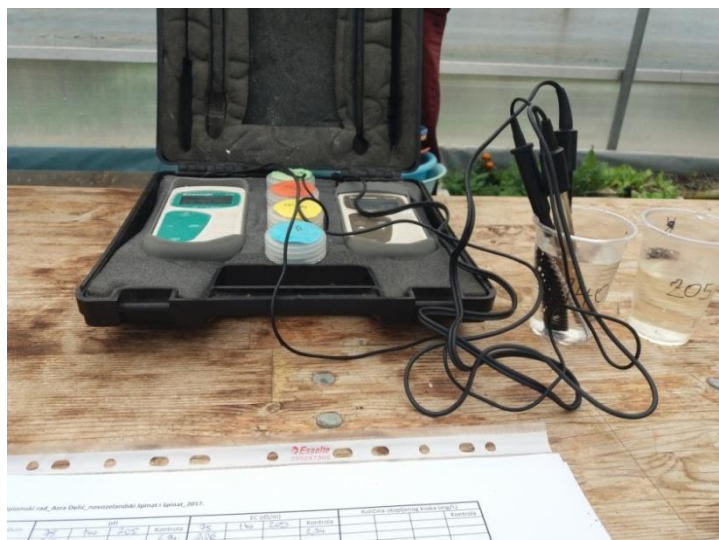
Slika 9. Mjerenje pH i EC vrijednosti hranivih otopina za uzgoj špinata i novozelandskog špinata (foto: Azra Delić, 2017)
