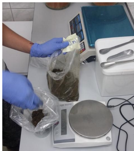
Slika 5a. Odmašćivanje F57 Ankom vrećica u acetonu; Slika 5b. Vaganje i homogeniziranje fecesa
