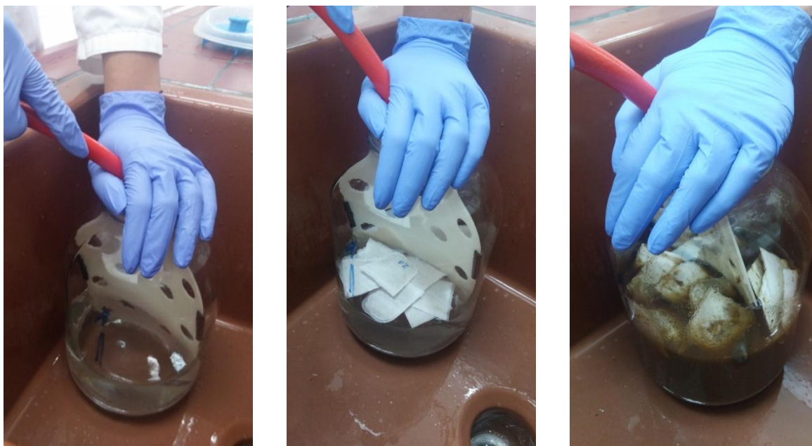
Slika 6a., 6b., 6c. Izbacivanje kisika iz anjum posuda pomoću CO 2 prije i nakon stavljanja uzorka te nakon stavljenog fecesa
