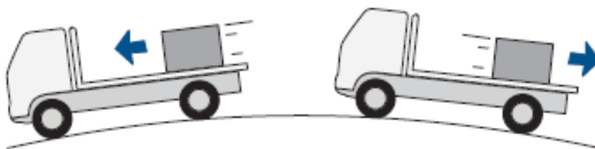
Slika 5.10. Pomak tereta prilikom transporta preko valovitih ili brdovitih cesta Izvor: Load restraint guide, 2004.
