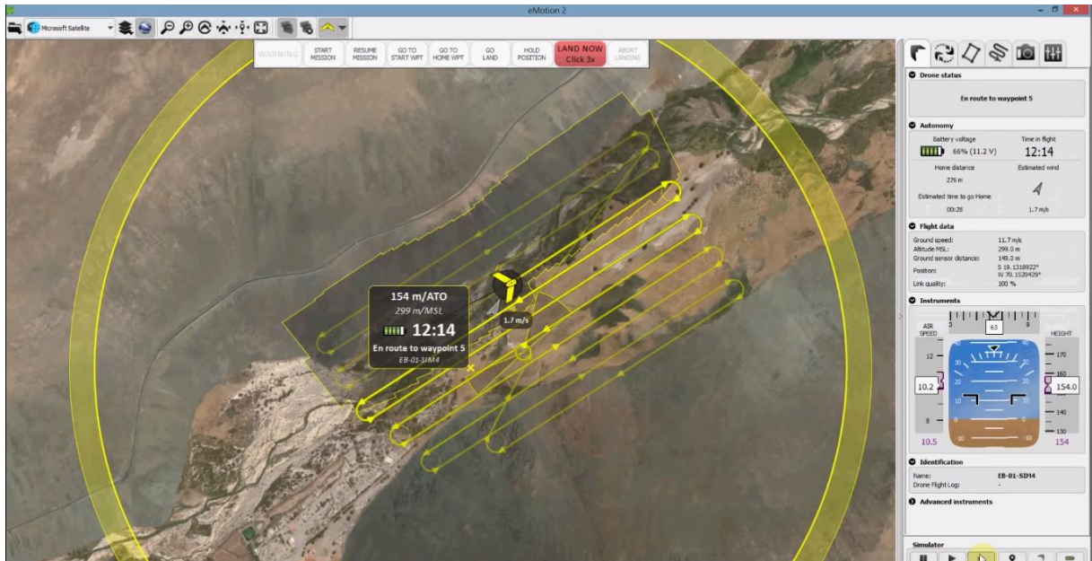
Slika 8.9. Prilagodba plana leta tijekom istog i provjera parametara na sučelju
