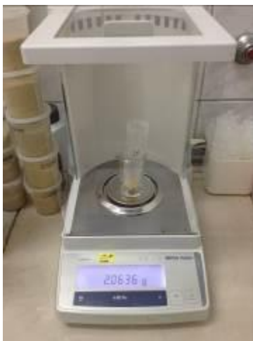
Slika 4.3.2. Uzorak izvagan na približno 2 g prilikom analize oksidacijske stabilnosti jaja (vlastiti izvor)
