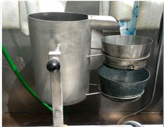
Slika 10. Spearsov flotacioni uređaj za ispiranje uzoraka (Dubičanac, 2014)
