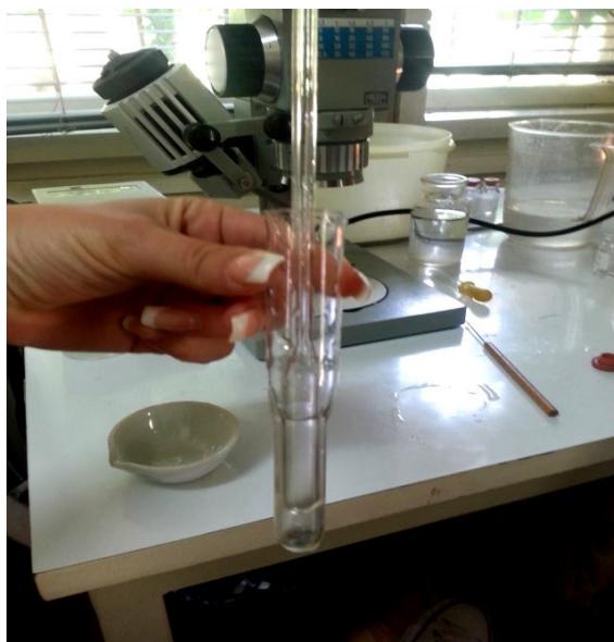
Slika 15. Drobljenje cista u Huijsmansovom homogenizatoru (Dubičanac, 2014)
