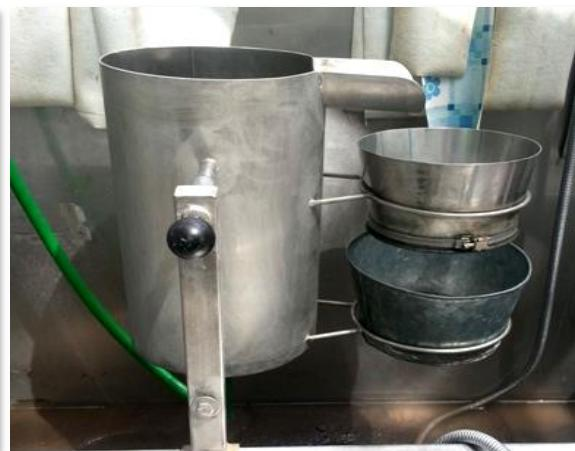
**Slika 10.** Spearov flotacioni uređaj za ispiranje uzorka (Dubičanac, 2014)
