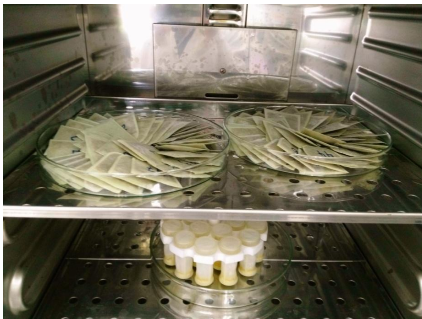
Slika 3.3.1.4. Sušenje uzoraka u sušioniku
