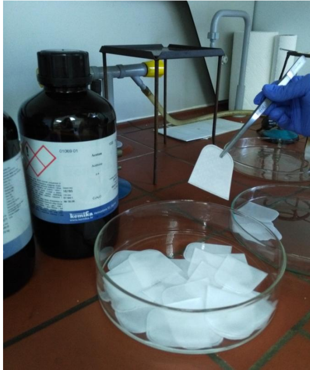
Slika 3.3.2.1. Odmaščivanje vrećica za određivanje probavljivosti Izvor: Vlastiti izvor
