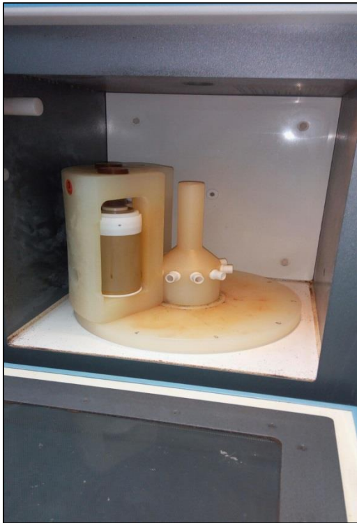
Slika 3.2.6. Slaganje uzoraka tretiranih smjesom kiselina u mikrovalnu peć Autor: Jurišić, 2016
