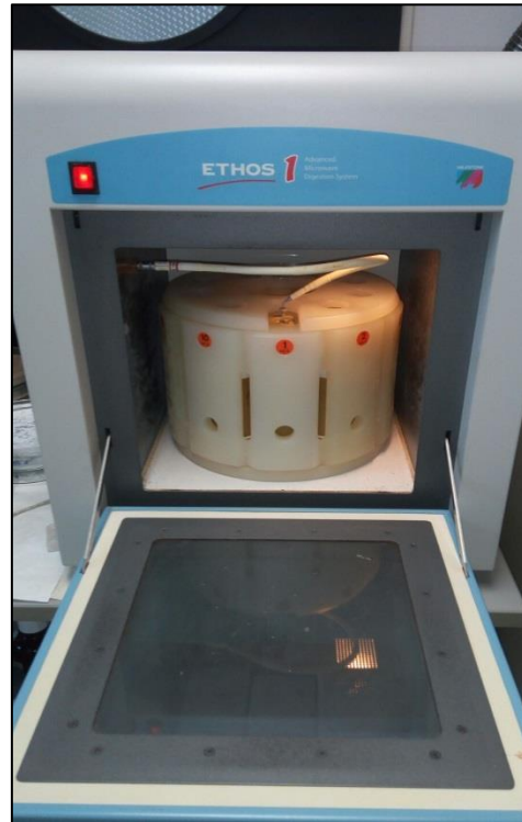
Slika 3.2.7. Mokro spaljivanje uzoraka u mikrovalnoj peći Autor: Jurišić, 2016
