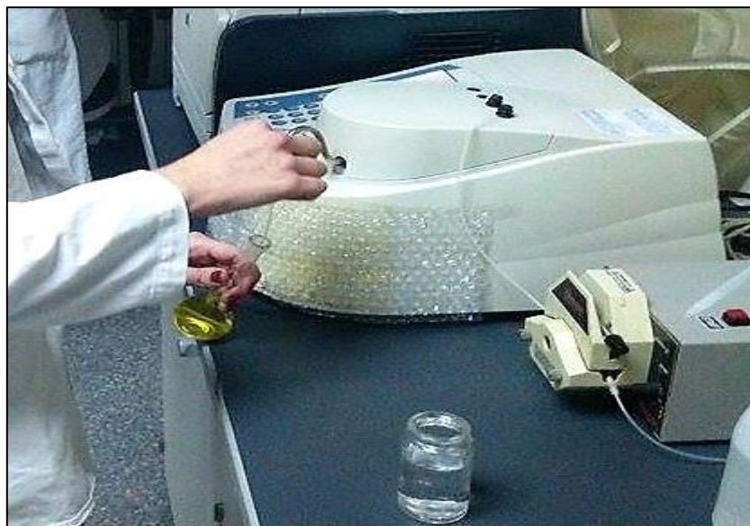
Slika 3.2.9. Očitavanje količine analita u otopini na spektrofotometru Autor: Jurišić, 2016
