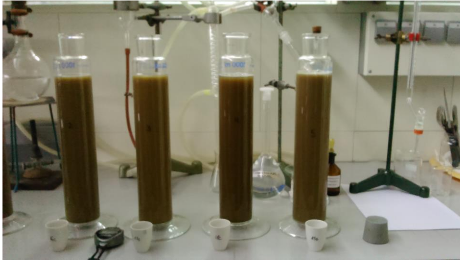
Slika 9. Cilindri za sedimentaciju sa suspenzijama tla pripremljeni za pipetiranje
