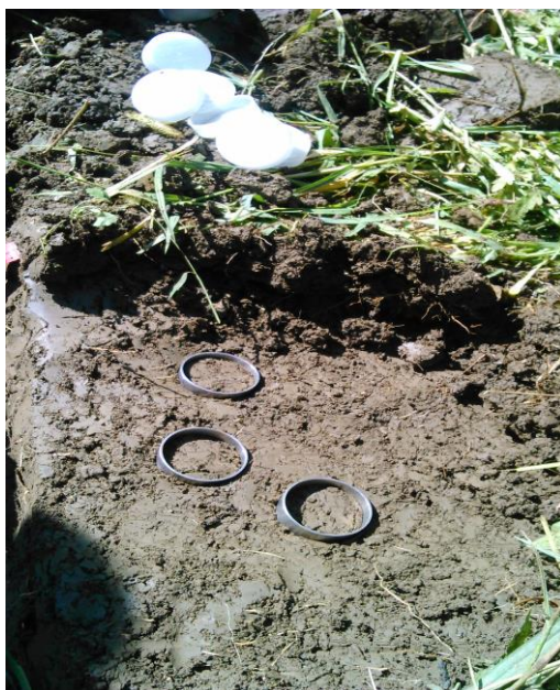
Slika 7. Uzimanje uzorka pomoću cilindra iz profila tla
