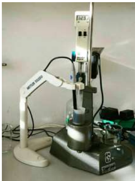
Slika 4. Određivanje pH vrijednosti (Fotografija: Daniela Patricia Bilić, 2016)
