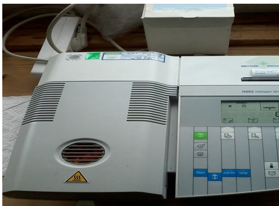
3.1.8. Halogeni vlagomjer Foto: Mate Andrijašević
