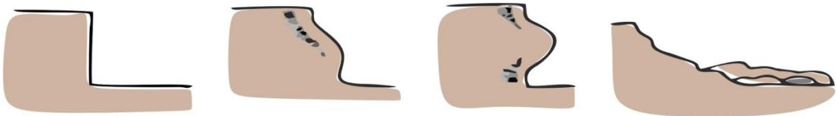
Slika 2.17. Utjecaj pritiska tla na zid; Izvor: http://www.alpter.net/IMG/pdf/UNIMI_bonardi_11_05.pdf
