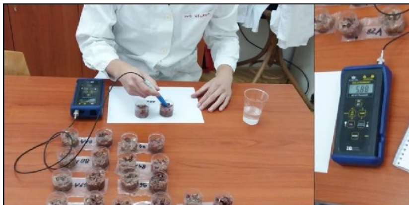
Slika 3.7. Mjerenje pH vrijednosti uz pomoć uređaja IQ150 Texas s BlueLine 21 Schott elektrodom
