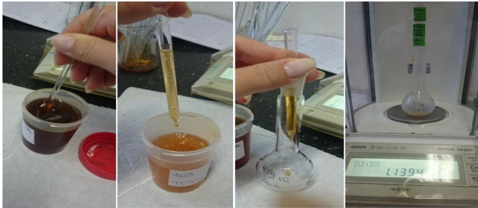
Slika 4: Prikaz homogenizacije, pipetiranja i vaganja uzorka meda
