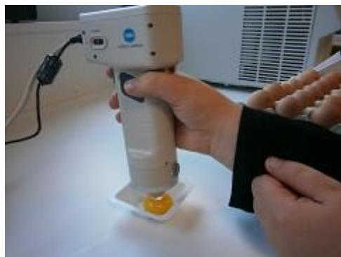
Slika 13. Kolorimetrijski uređaj Chroma metar CR-410, Minolta, Japan
