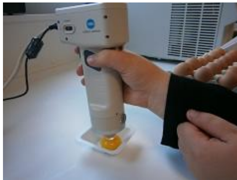
Slika 13. Kolorimetrijski uređaj Chroma metar CR-410, Minolta, Japan
