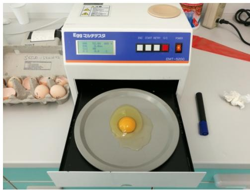
Slika 11. Automatski uređaj za mjerjenje boje žutanjka-Egg Multi-Tester EMT-5200
