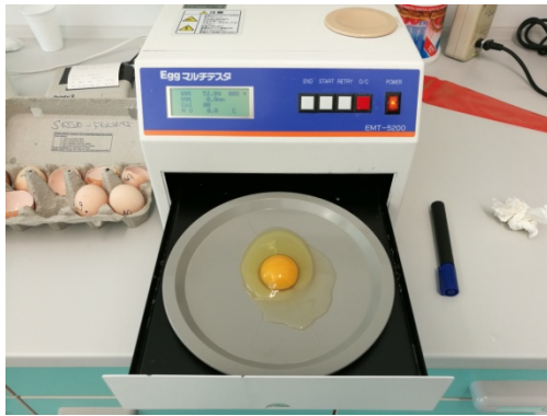
Slika 11. Automatski uređaj za mjerenje boje žutanjka-Egg Multi-Tester EMT-5200
