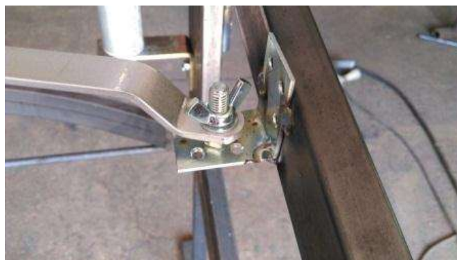
Slika 47. Leptir matica sigurnosnog sustava odvajanja poluge
