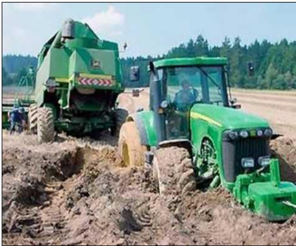
Slika 23. Prikaz gaženja tla teškim strojevima u nepovoljnim uvjetima vlažnosti i prikaz formiranja svoda u podoraničnoj zoni drenažnog jarka
