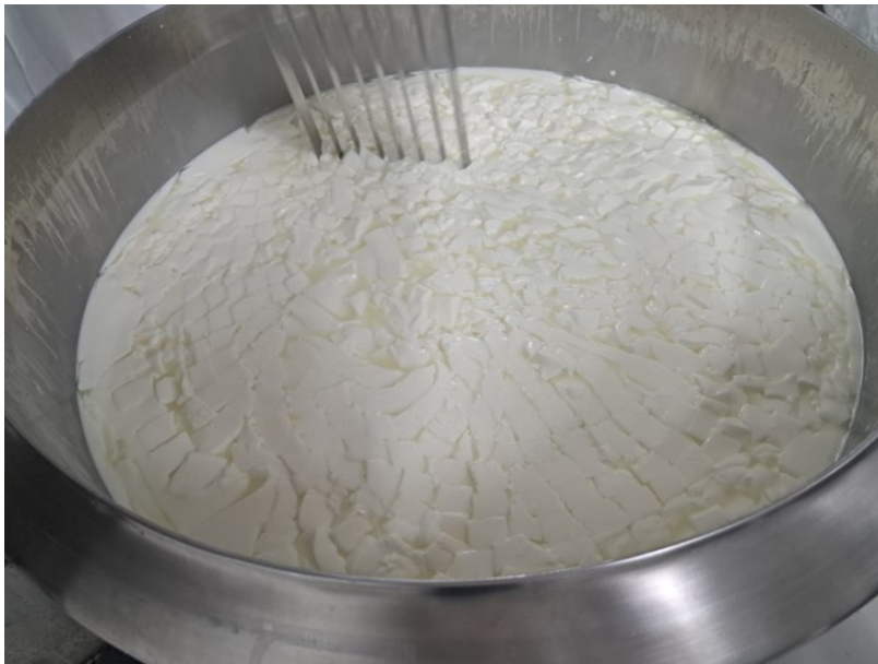
3.1.2. Rezanje gruša sirarskom harfom
